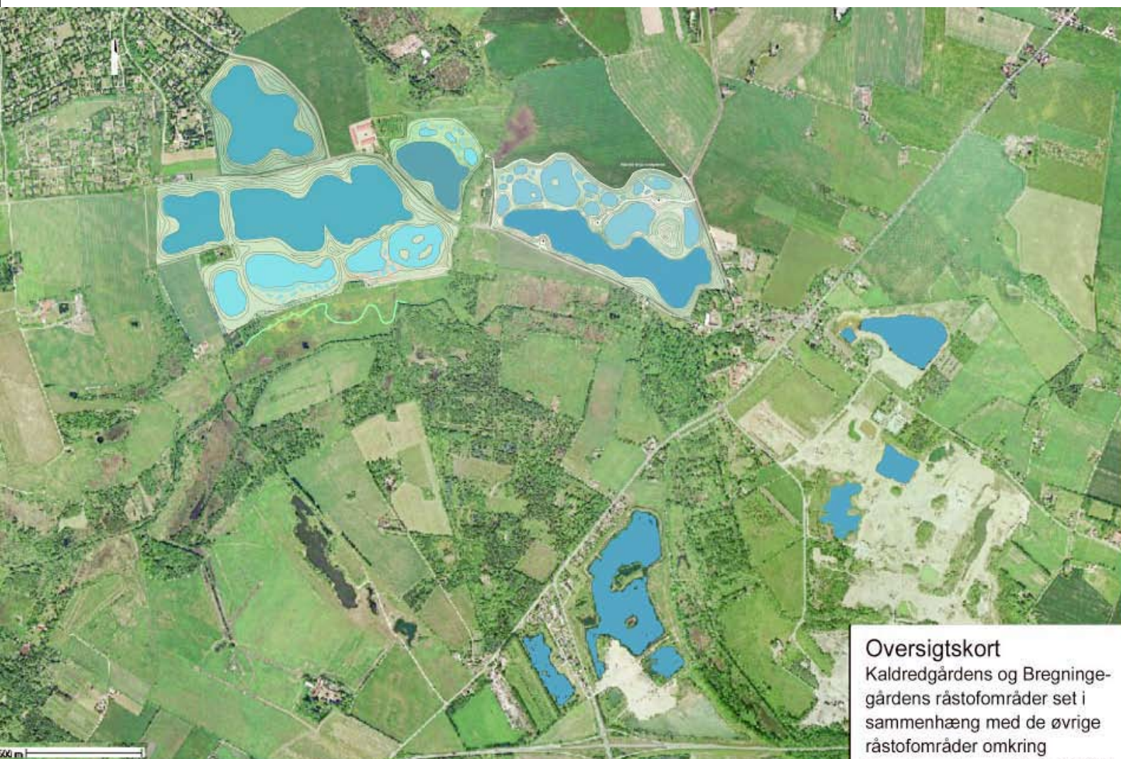
Figur 3.1. Skitseforslag for efterbehandling for Kaldredgården set i sammenhæng med de færdiggravede arealer på Bregningegård. Det er vigtigt at bemærke, at figuren er et skitseforslag, som beskriver nogle af principperne omkring fordeling af små og store samt lave og dybe søer. Det er derfor langt fra sikkert, at det endelige resultat ser således ud.
