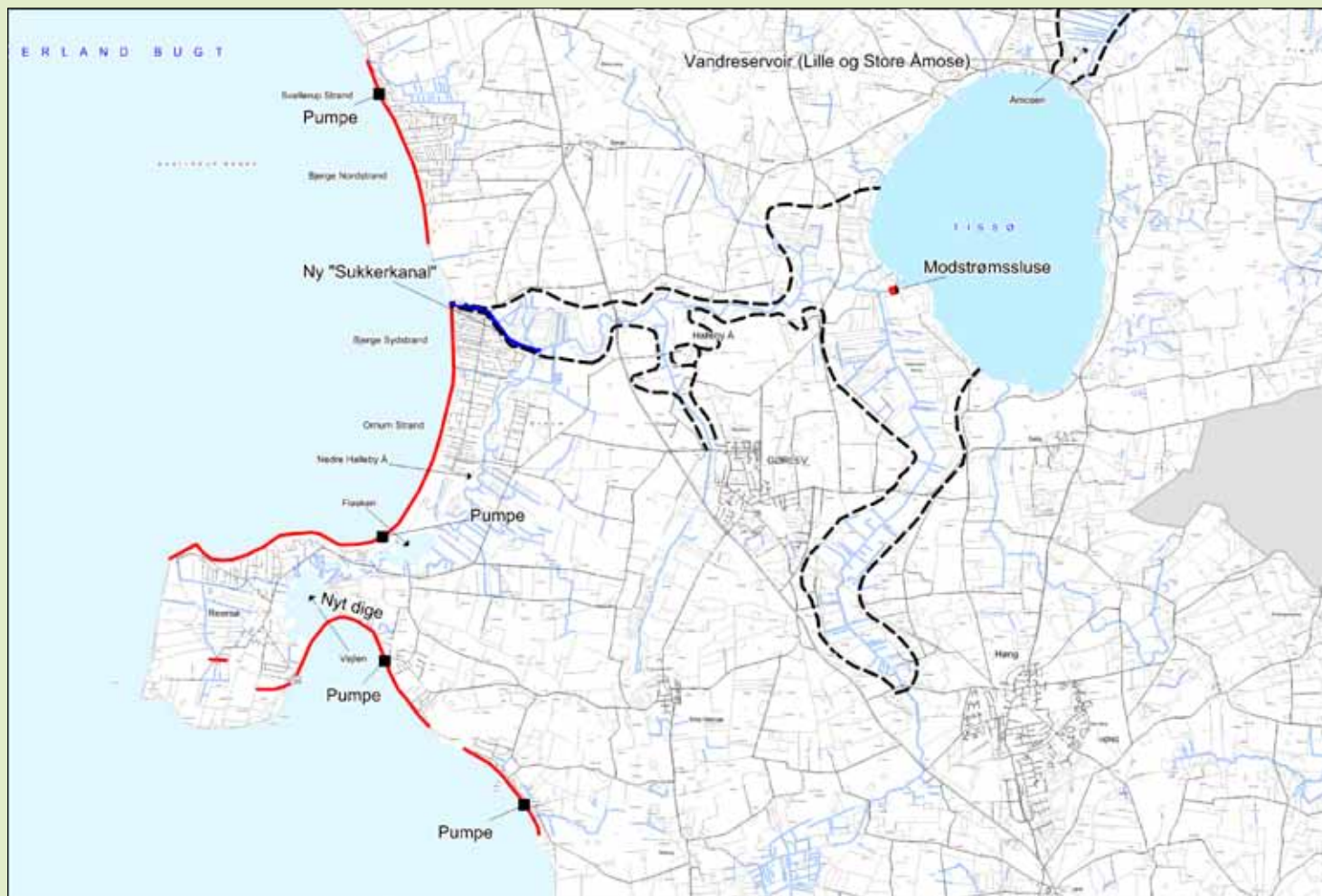
Kort 3. Forslag 2: Stordiger på kyst og land. Den røde linie angiver kystdiger. Den sorte, stiplede linie angiver vandløbsdiger. Den blå linie angiver det nye udløb for Halleby Å.
