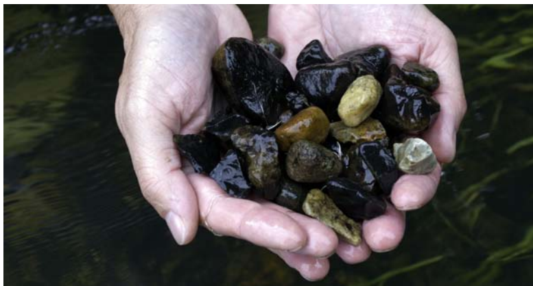
Det anbefalede gydegrus til vandløbsrestaurering er småsten på størrelse med valnødder, hvor ca. 75 % er sten i størrelsen 16-32 mm og 25 % er 33-64 mm.
