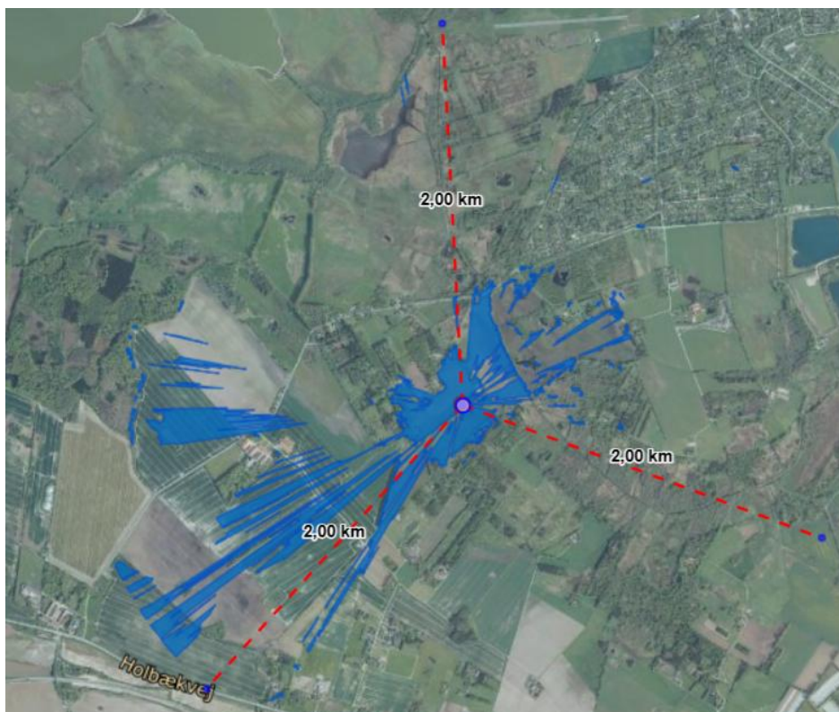
5 – Synlighed af støjvold med en højde på 11 m i 2 km afstand
