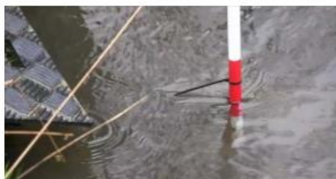
Figur 8 En landmålerstok med afsatte mærker for den ønskede vandstand er et simpelt og godt redskab til at sikre sig, at vandstanden holdes på det ønskede niveau.
