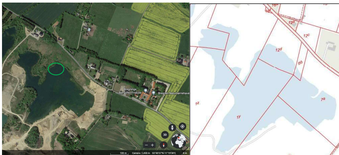
Figur 1. Oversigtskort over grusgraven (både GoogleEarth kort og matrikelkort), hvortil vand fra borearbejdet ifm. boring af prøveboringerne forventes udledt med en evt. vandspejlsstigning til følge. For at kunne dokumentere en sådanne stigning foretages monitoring af vandstanden i grusgraven. Et cirka udlednings- og monitoringsområde er markeret med en grøn cirkel på GoogleEarth kortet.
