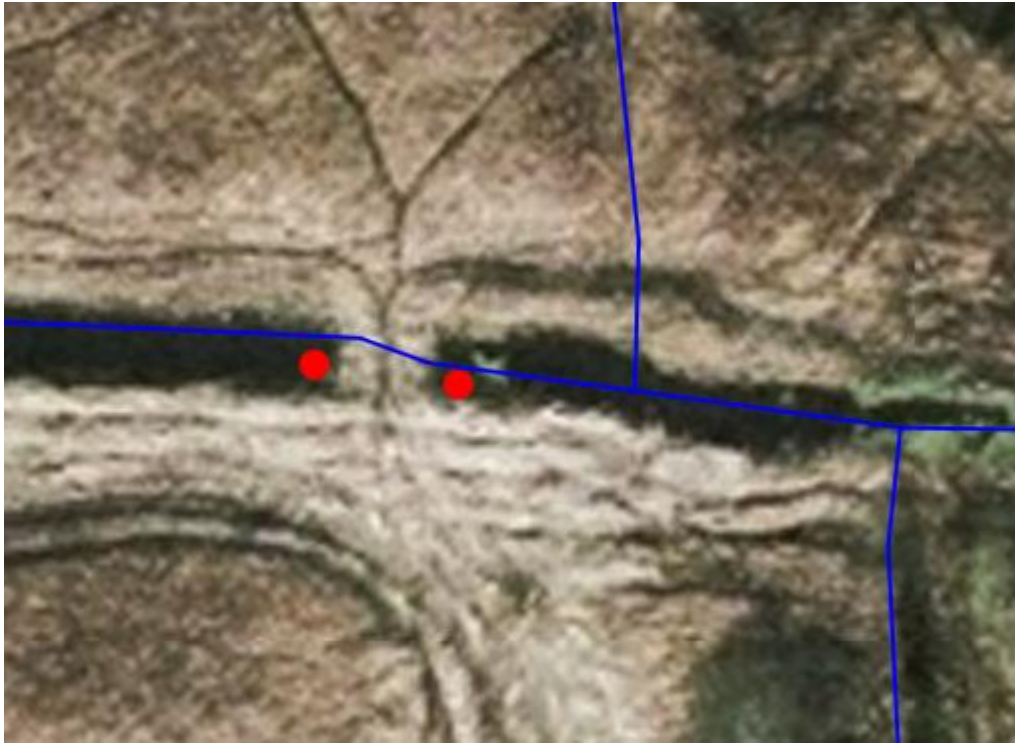
Figur 3 To punkter i regulativet, der er blevet justeret manuelt ved en rørunderføring.
